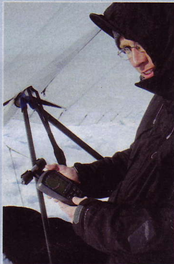
▲ MITTARI kertoo korkeuden, nousu- tai laskunopeuden, lentonopeuden ja lämpötilan sekä uusimmat mallit lisäksi paljon muuta hyödyllistä tietoa.
